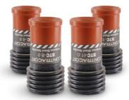
Sehr verschleißresistente Venturi Strahldüsen, hergestellt aus Wolframkarbid (TC). **Lifespan:** Up to 400 hours. **Covering:** Rubber. **Thread:** Rubber, 50 mm for NHP nozzle holder. **Inlet opening:** 25 mm.
