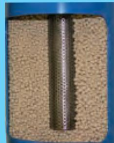
Ciascuna colonna ha diffusori in entrata ed uscita, realizzati in acciaio inossidabile, per garantire un'ottima distribuzione dell'aria compressa sul materiale adsorbente.
