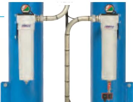
Gli essiccatori sono forniti con un filtro disoleatore 0.01 micron in ingresso (con scaricatore automatico) e anti-polvere 1 micron in uscita. Dotati entrambi di manometro differenziale, sono facilmente raggiungibili per la manutenzione e rientrano nell'ingombro dell'essiccatore.
